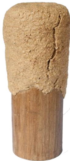
Figura 65. Material SSF en prueba de adherencia y pérdida de humedad sobre una pieza de bambú.
