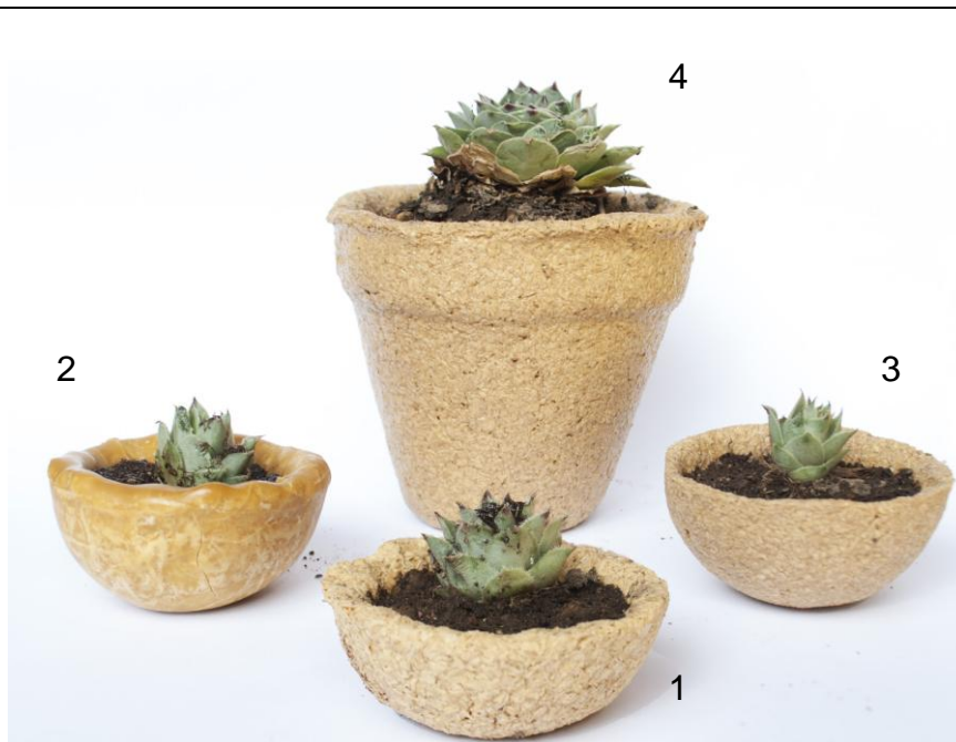
Figura 68. Material SSF en distintas pruebas de resistencia de humedad.
