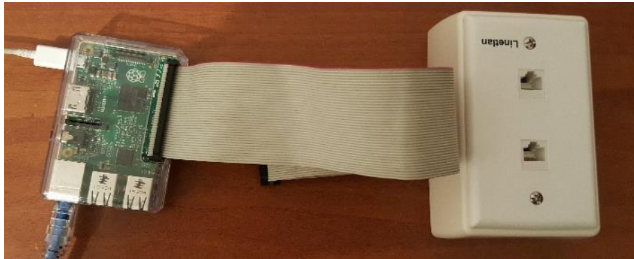
Figura 50. Conexión desde el Raspberry hacia los relés
