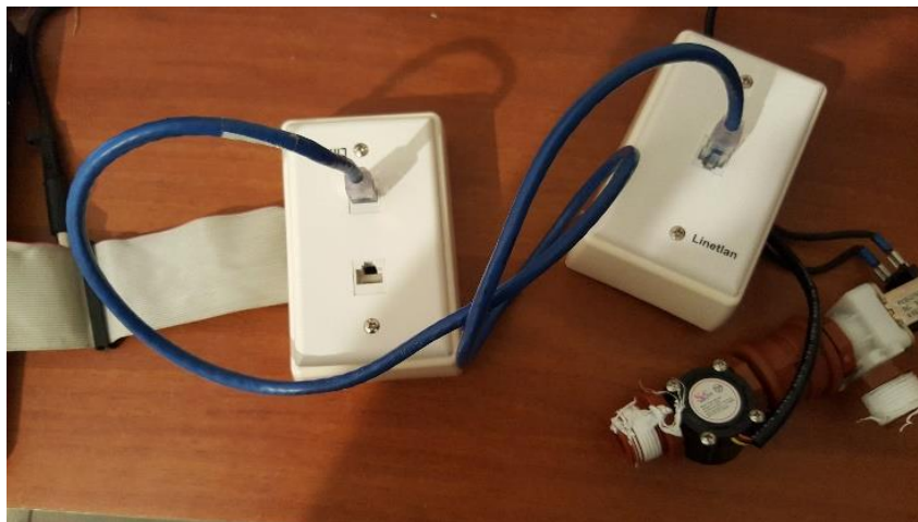
Figura 51. Conexión hacia las electroválvulas
