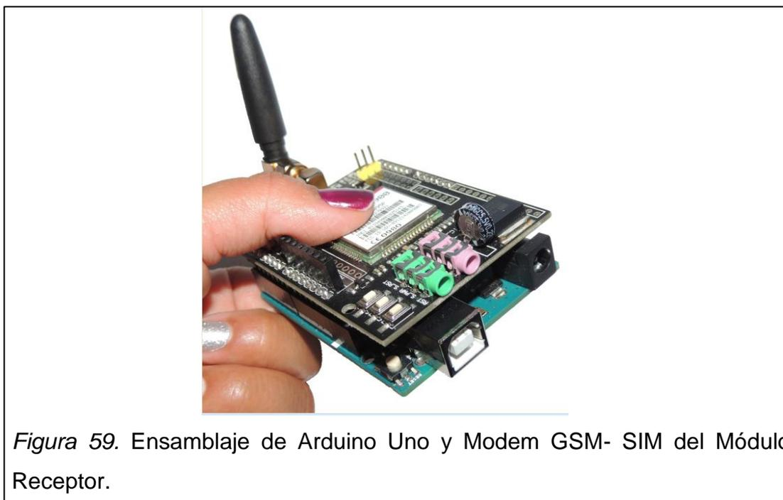
Figura 59. Ensamblaje de Arduino Uno y Modem GSM- SIM del Módulo Receptor.
