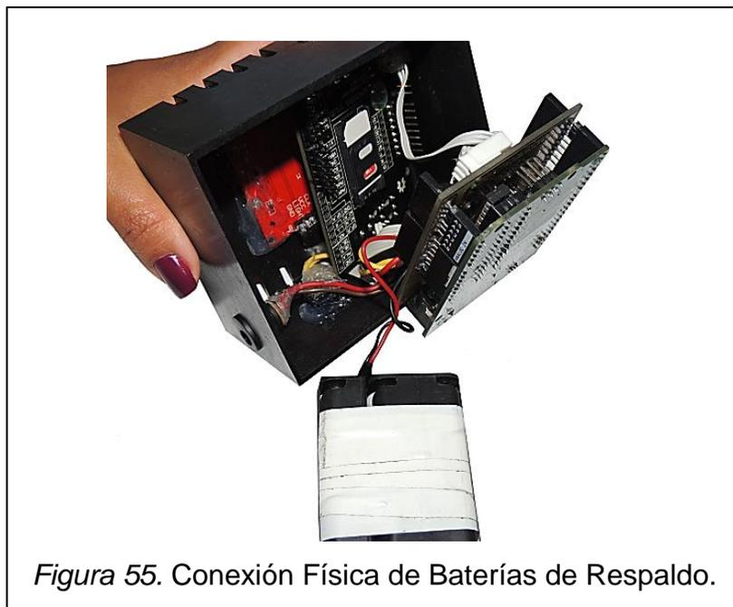
*Figura 55. Conexión Física de Baterías de Respaldo.*
