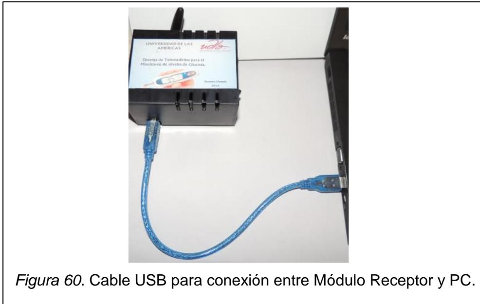
*Figura 60.* Cable USB para conexión entre Módulo Receptor y PC.
