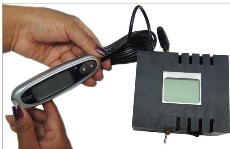
Figura 4: Conexión entre el glucómetro y módulo emisor
