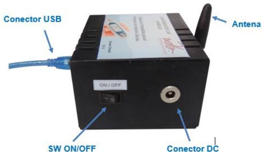
Figura 1: Módulo receptor partes importantes
