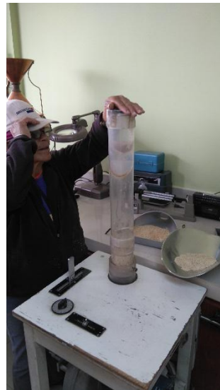
Equipo del lecho fluidizo, para separación de impurezas
