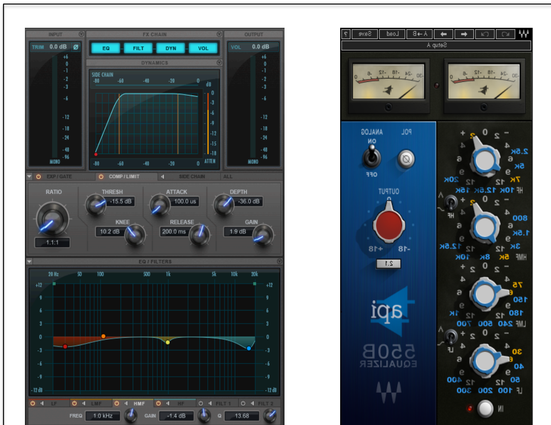
Figura 47: Ecuación y compresión para el canal de la flauta (arriba). Efecto de reverberación para el mismo (abajo).
