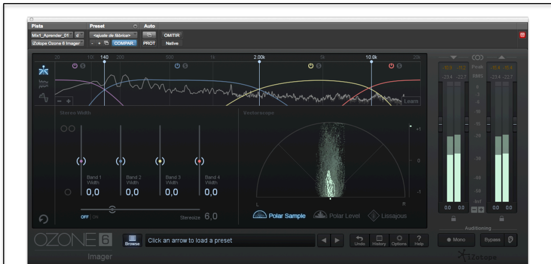
Figura 33: Se panearon frecuencias específicas para engrandecer el espectro sonoro.
