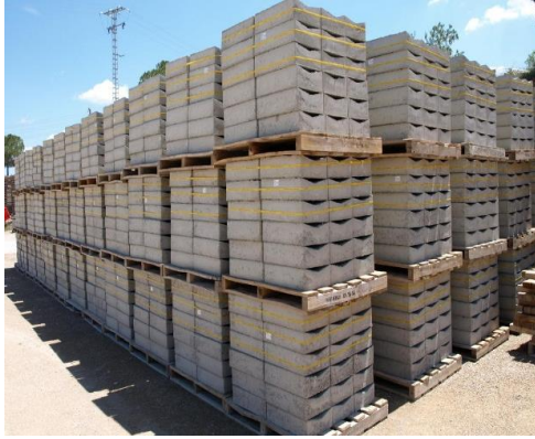
Figura 2.2.1. a.- Losas de hormigón Prefabricado.
