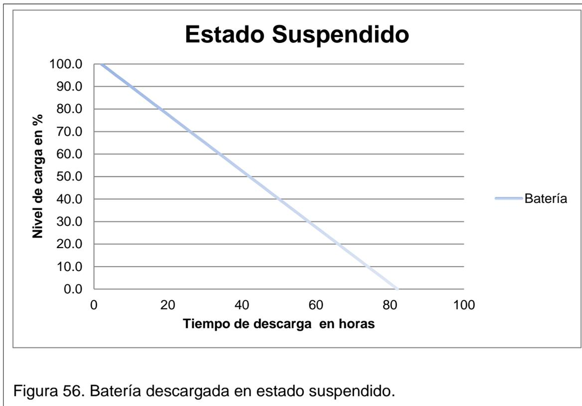
La Figura 56 expone como la batería se descarga en el estado suspendido en aproximadamente 82 horas (alrededor de 4 días). Las mediciones se encuentran en el Anexo 8.
