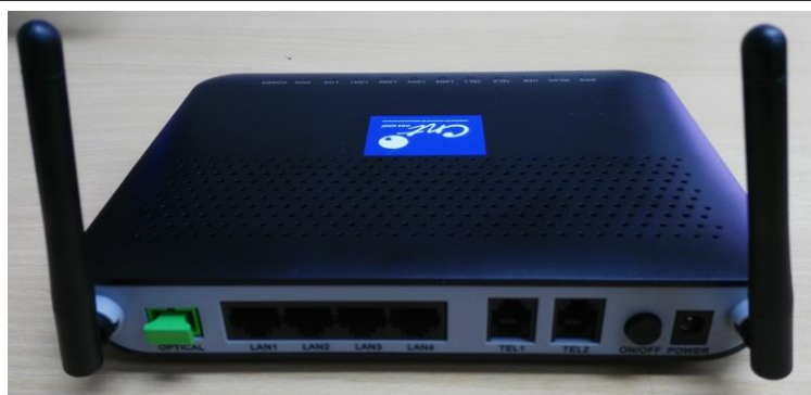
Figura 39. Equipo terminal ONT. Tomado de (CNT E.P. s.f.)
