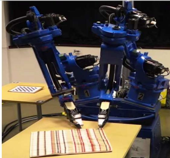
**Figura N° 31.** Robot que plancha y dobla la ropa
