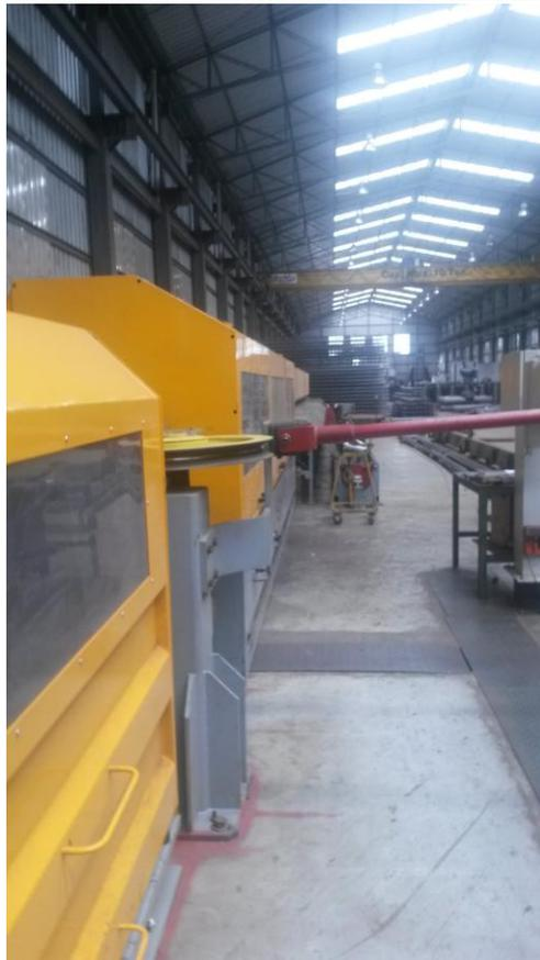
*Figura 7 - Máquina Trefiladora*
