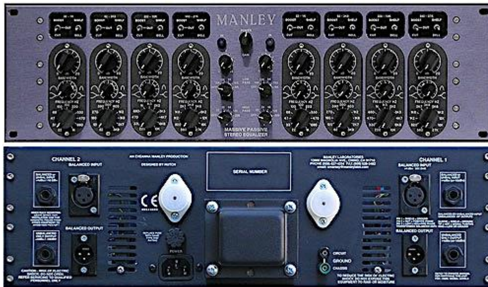
Figura 15. Panel frontal y posterior del Manley Massive Passive.
