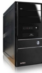
Figura 30. CPU con Windows Xp, procesador I3 y cuatro Gb de memoria Ram.
