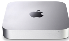
Figura 52. Mac Mini con un procesador I7 con 8Gb de Memoria Ram con Sistema Operativo Os X Mavericks
