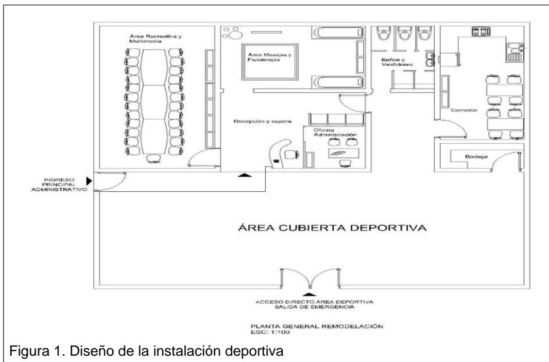
Figura 1. Diseño de la instalación deportiva
