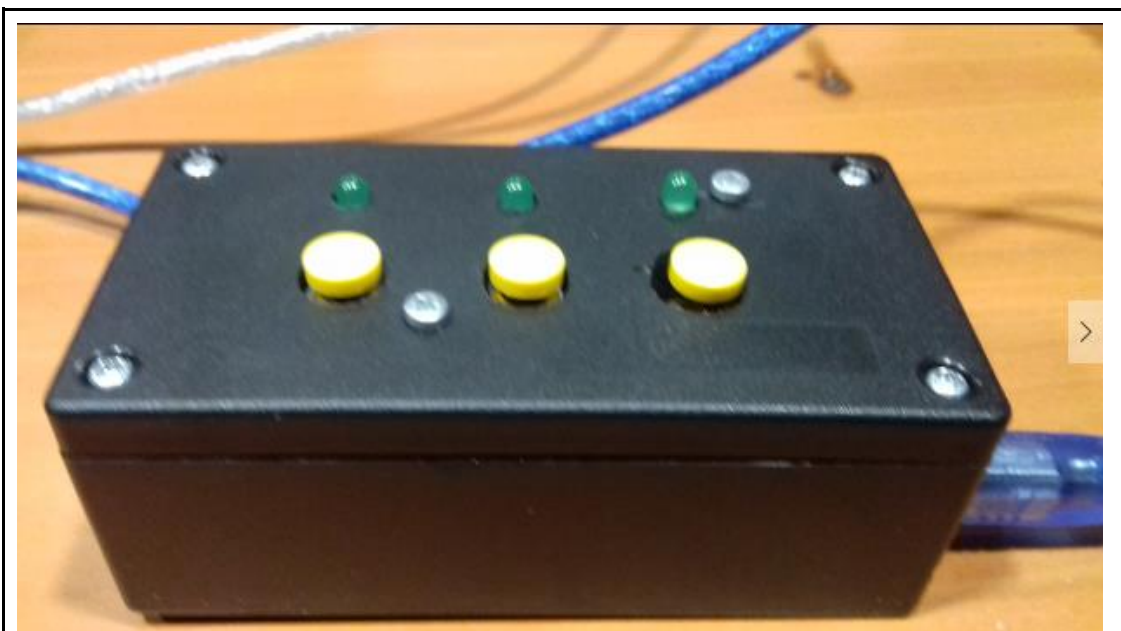
Figura 43. Detalle del botón de respuestas implementado.
