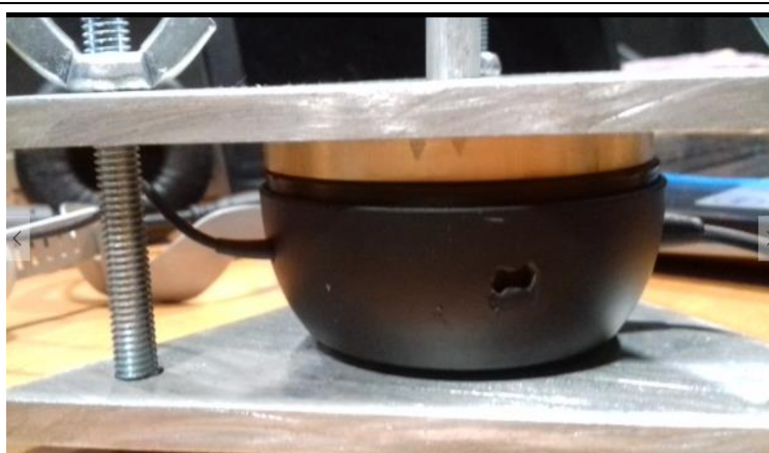
Figura 46. Audífono DT 1350 derecho modificado.
