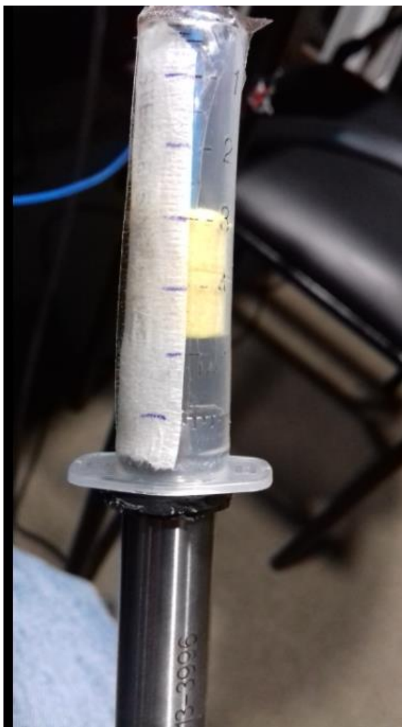
Figura 40. Utilización de la jeringa para la obtención de niveles acústicos.
