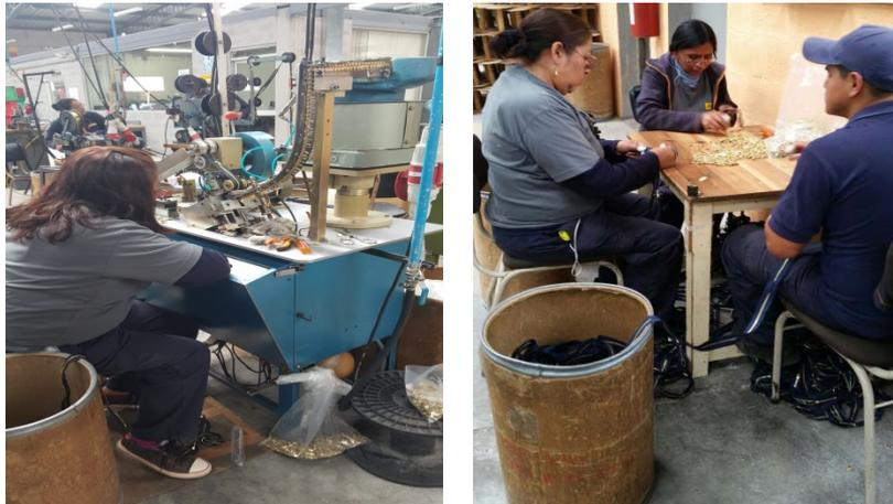
Figura 21. Colocación de cursores (automáticamente y manualmente)
