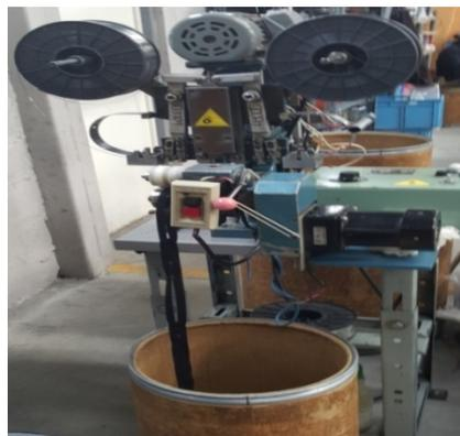
Figura 22. Colocación de topes superiores
