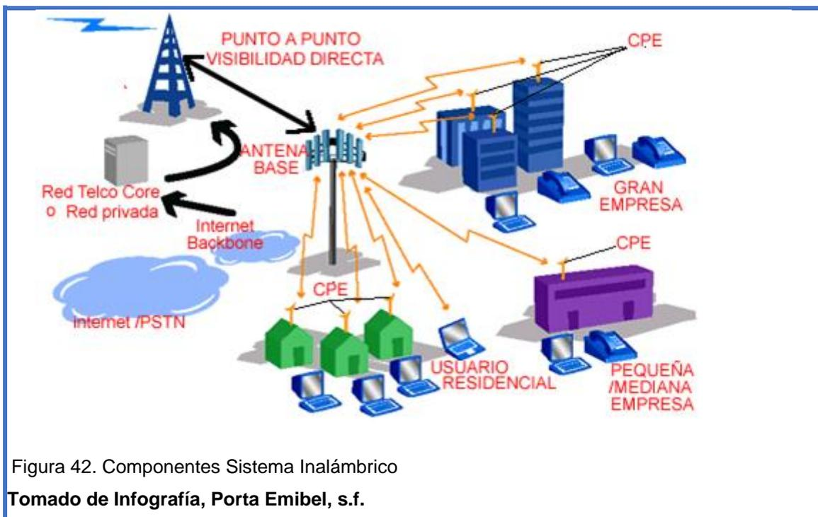
Figura 42. Componentes Sistema Inalámbrico
