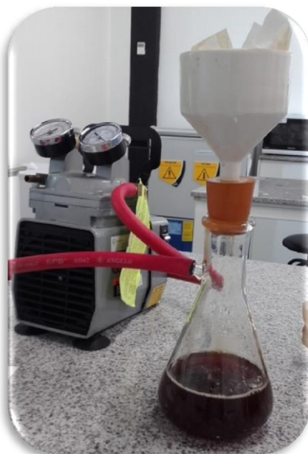
Anexo 12. Filtración al vacío de los extractos de taninos de harina de guarango.
