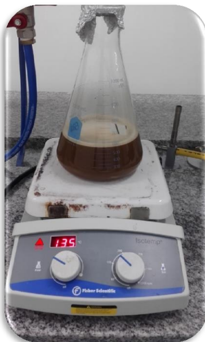
Anexo 11. Extracción de los taninos de harina de guarango. Calentamiento de la solución al 50% de solvente alcohólico y agua destilada con 150 g de harina de guarango a 135°C, 210 RPM durante 30 minutos.
