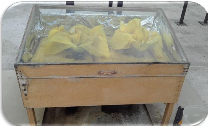
Anexo 16. Secador solar donde se realizó el secado de la biomasa obtenido luego de la floculación biológica y química.
