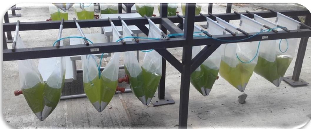
Anexo 10. Fotobiorreactores de 10 L inoculados con 130 mL de la cepa CMIE-A1-004 del género Chlorella sp.1.
