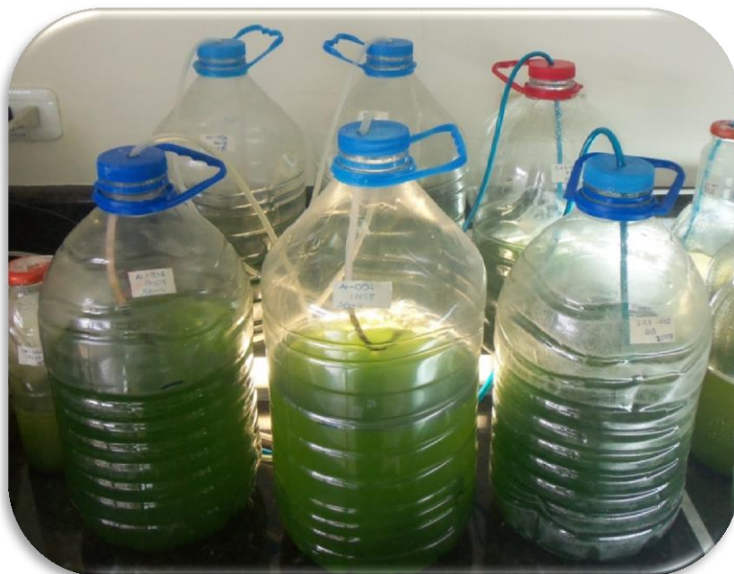
Anexo 9. Escalado por duplicado de las tres cepas de microalgas seleccionadas: CMIE-A1-004 del género Chlorella sp.1, CMIE-I4.2-002 del género Chlorella sp.2 y CMIE-A3-006 del género Scenedesmus sp.
