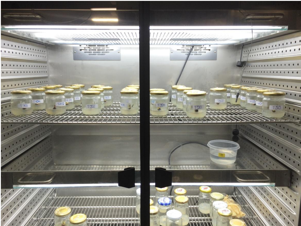
Foto 14. Cámara de estabilización
