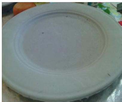
Figura 35. Pieza en crudo seca, presenta el color gris característico.
