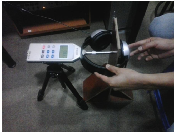
Figura 47. Proceso de medición de respuesta de audífonos
