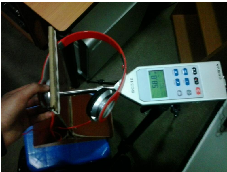
Figura 49. Ejemplo de proceso de medición de niveles de audífonos.
