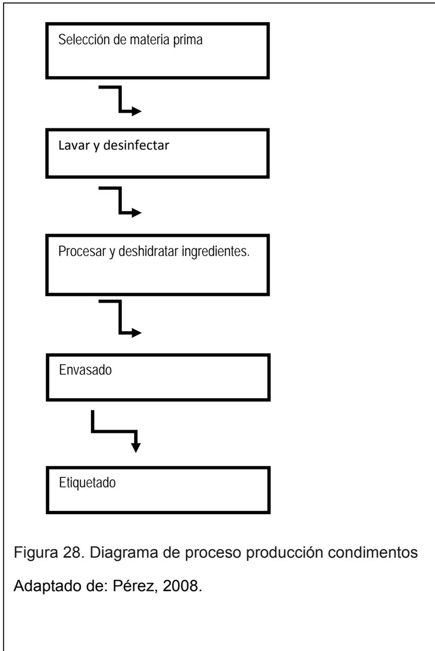
Figura 28. Diagrama de proceso producción condimentos
