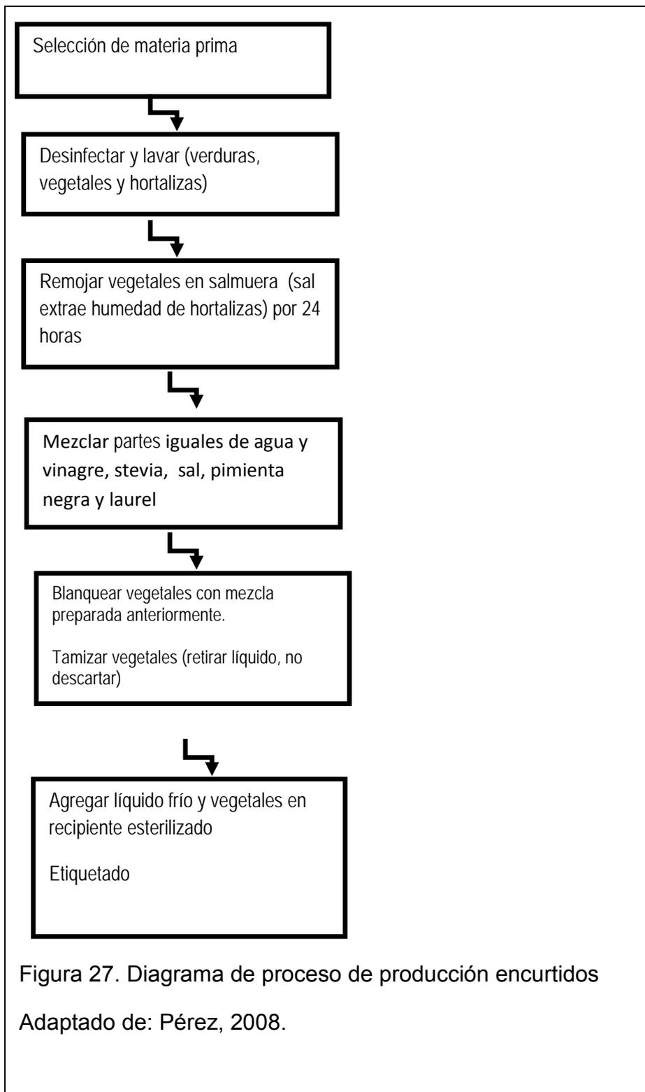
Figura 27. Diagrama de proceso de producción encurtidos
