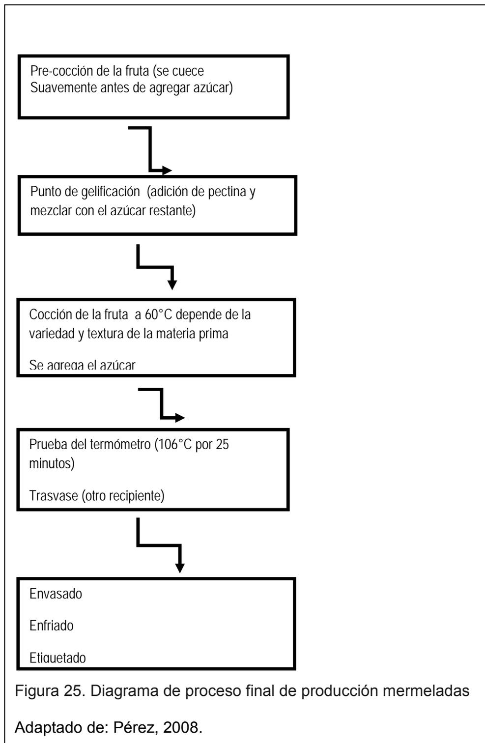
Figura 25. Diagrama de proceso final de producción mermeladas
