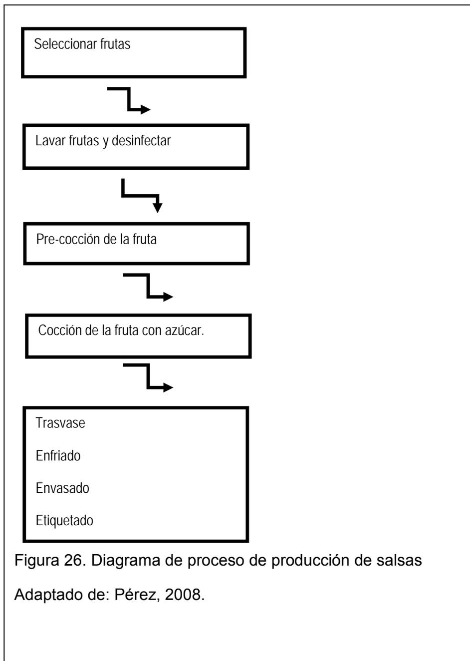
Figura 26. Diagrama de proceso de producción de salsas
