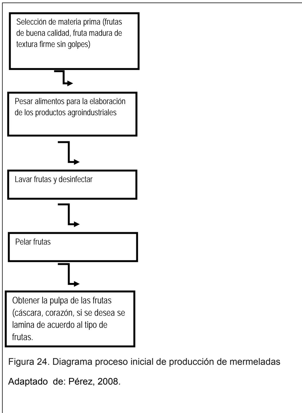
Figura 24. Diagrama proceso inicial de producción de mermeladas
