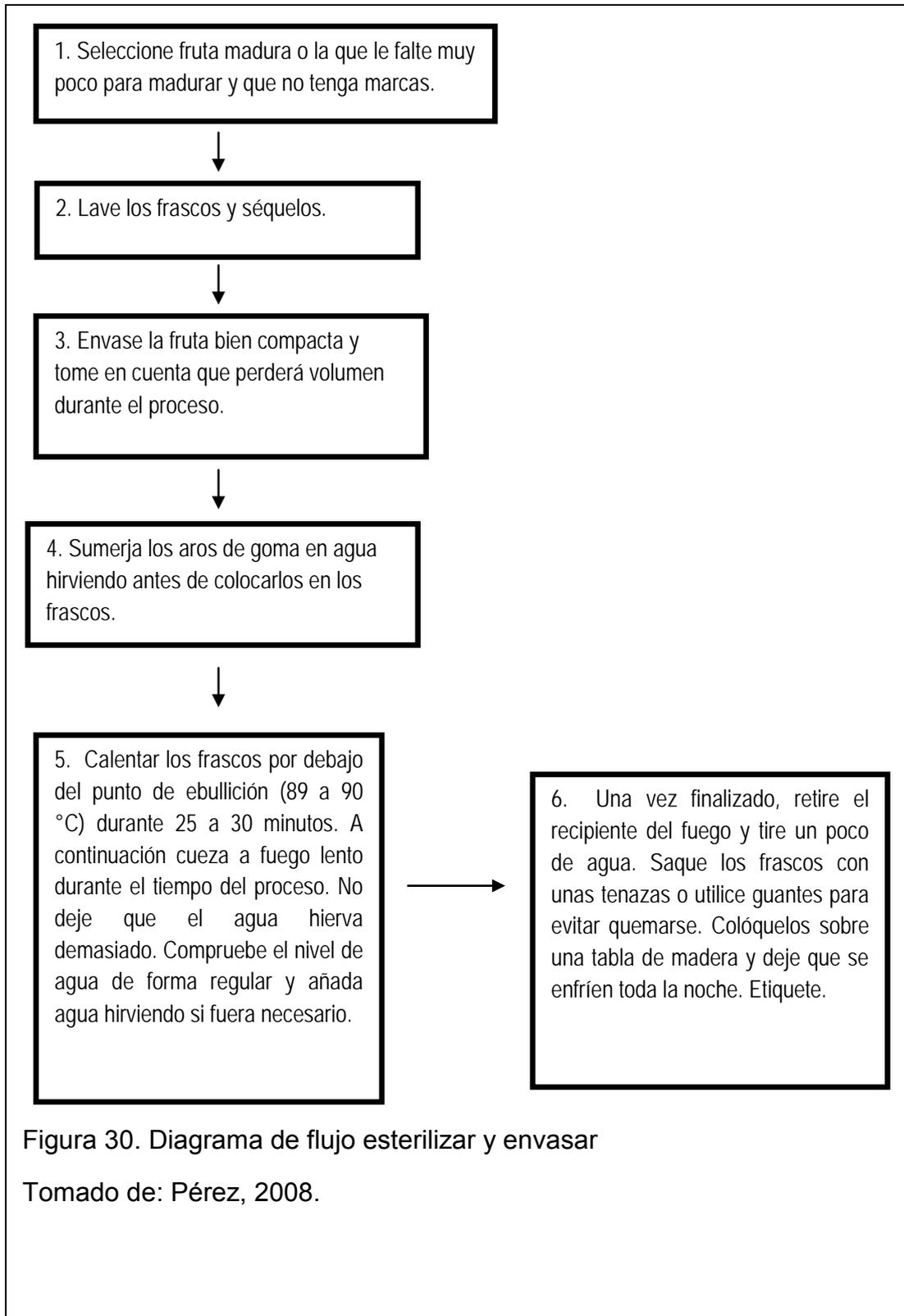
Figura 30. Diagrama de flujo esterilizar y envasar
