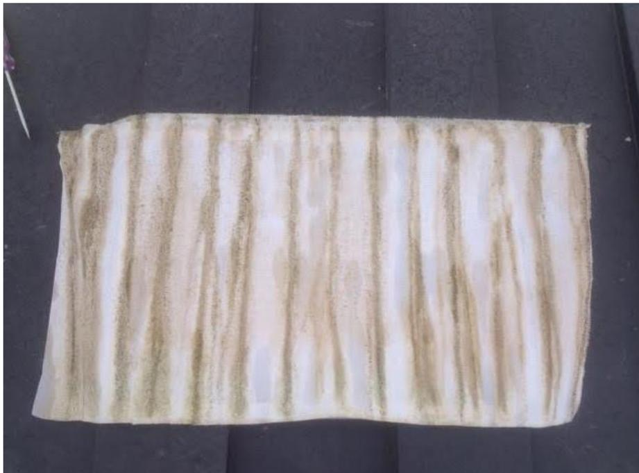
Figura 21. Biofiltro con biomasa seca.
