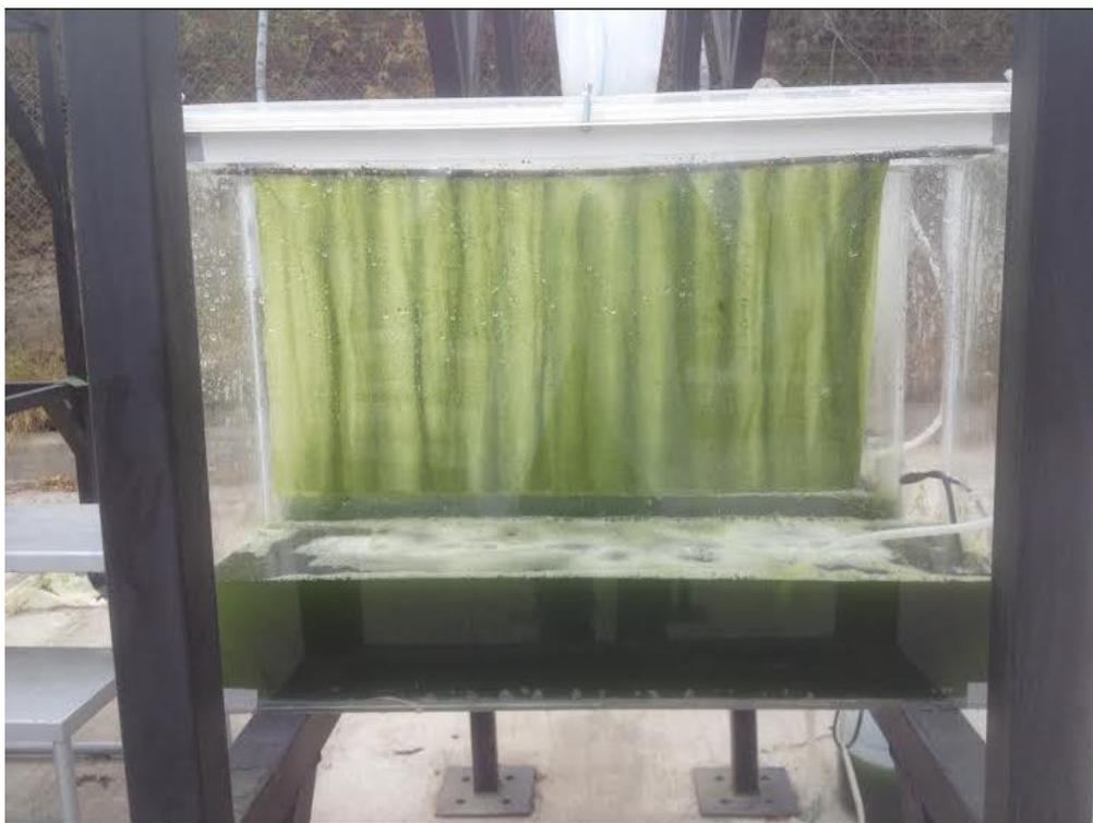
Figura 24. Estado final del biorreactor con una concentración del 10% de CO<sub>2</sub>
