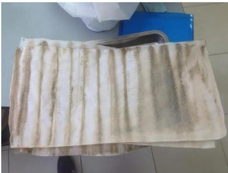
Figura 29. Biofiltro con biomasa seca.
