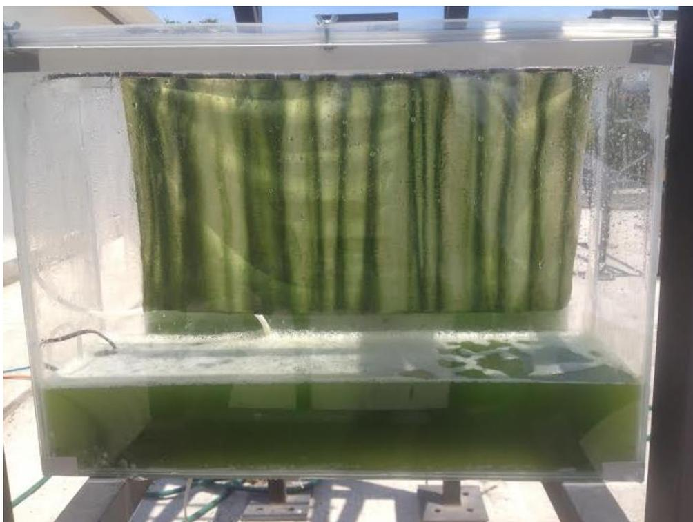
Figura 28. Estado final del biorreactor con una concentración del 15% de CO<sub>2</sub>.
