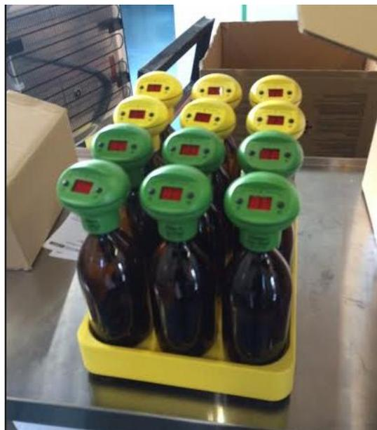
Figura 14. Botellas OxiTop, para la determinación de  $\text{DBO}_5$
