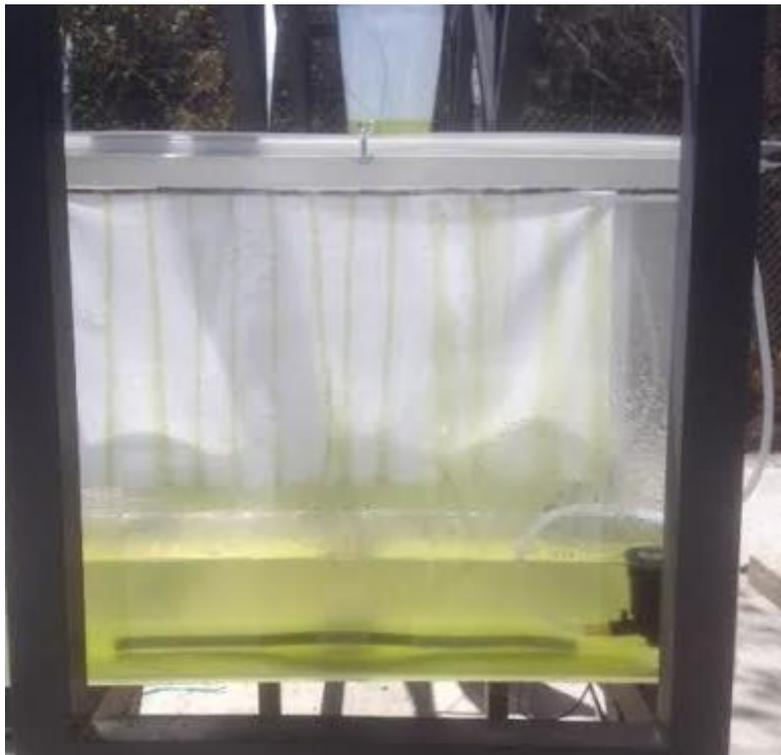
Figura 18. Estado inicial del biorreactor con una concentración del 5% de  $\text{CO}_2$
