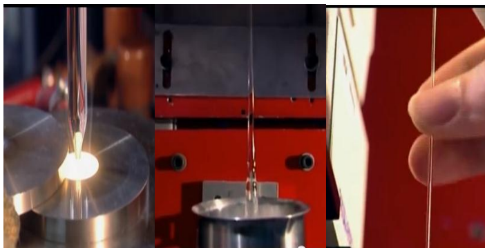
Figura 9. Tubos de vidrio fusionados
