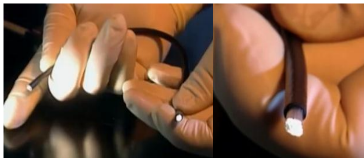
Figura 10. Tubos de vidrio fusionados
