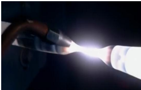
Figura 8. Tubos der vidrio fusionados
