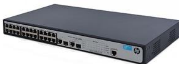
Figura 68. Switch HP 1910-24-PoE+ Switch (JG539A) Tomado de (HP, s.f.)
