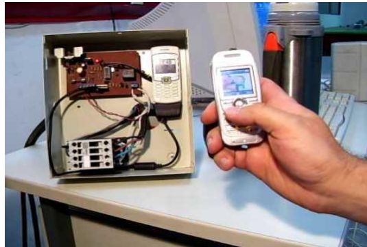
Figura 20. Control remoto de equipos e instalaciones Tomado de (Weinzierl, 2015)
