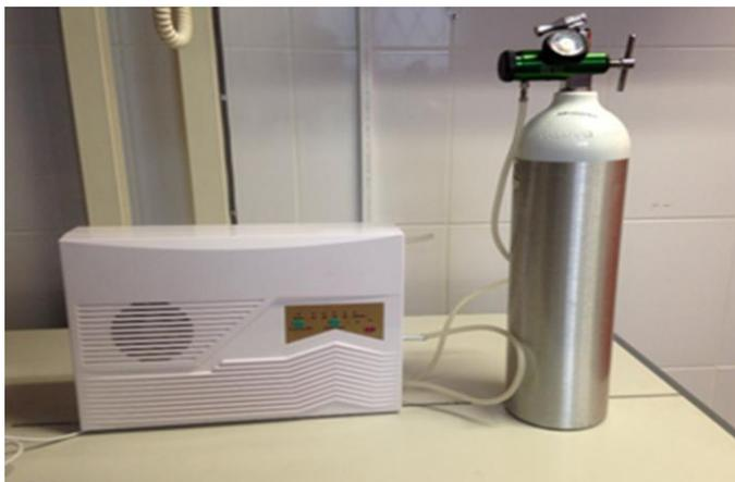
Anexo 9, Figura 29.- Generador de ozono Domo 400®; Tanque de oxígeno M6B 164L; Manómetro para tanque de oxígeno Drive® .
