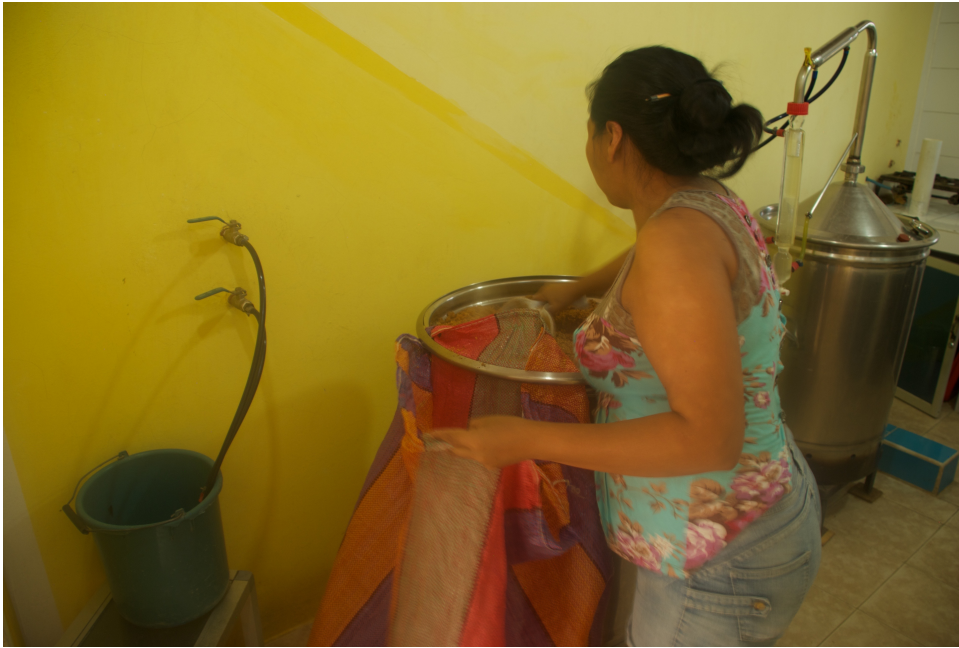
Figura 28. Proceso de arrastre de vapor para la extracción del aceite.
