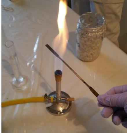
Figura 14. Esterilización de pinzas
