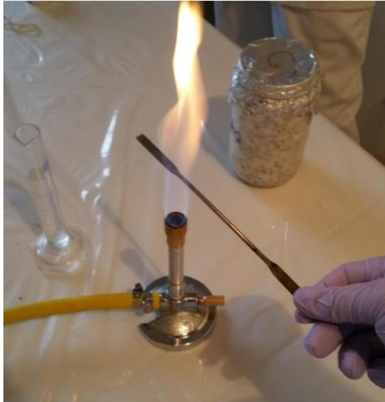
Figura 10. Esterilización de pinzas
