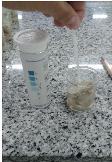
Figura 32. Tira de peróxidos sumergida en muestra acuosa.
