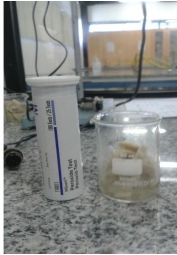
Figura 31. Test de peróxido y dilución de la muestra de salchicha de pollo.
