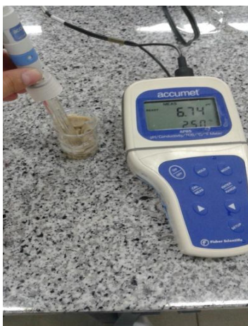
Figura 30. Determinación de pH en muestras de salchichas de pollo.
