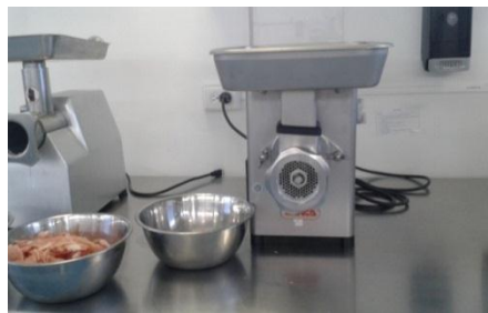
Figura 10. Proceso de reducción de tamaño de carne de pollo a 3 mm, en molino MAINCA.
