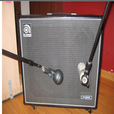
Figura 63. Micrófonos para el amplificador de bajo
