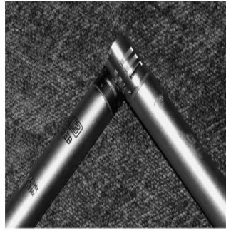
Figura 10. Técnica de grabación X/Y Coincidente
