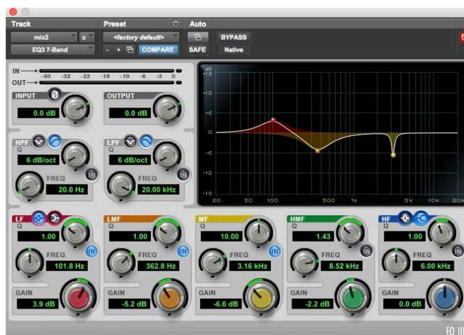
Figura 49. EQ de 7 bandas utilizado para atenuar y resaltar frecuencias.
