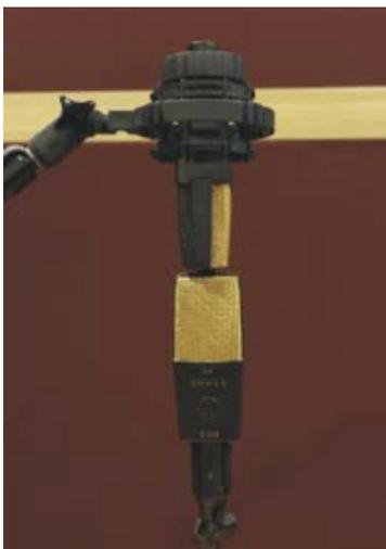
*Figura 68.* Técnica *Mid-Side*, utilizada en el CR3
