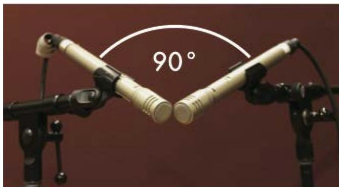
Figura 67. Técnica XY, utilizada en el CR3
