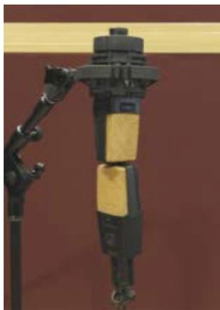
Figura 69. Técnica *Blumlein Array*, utilizada en el CR3
