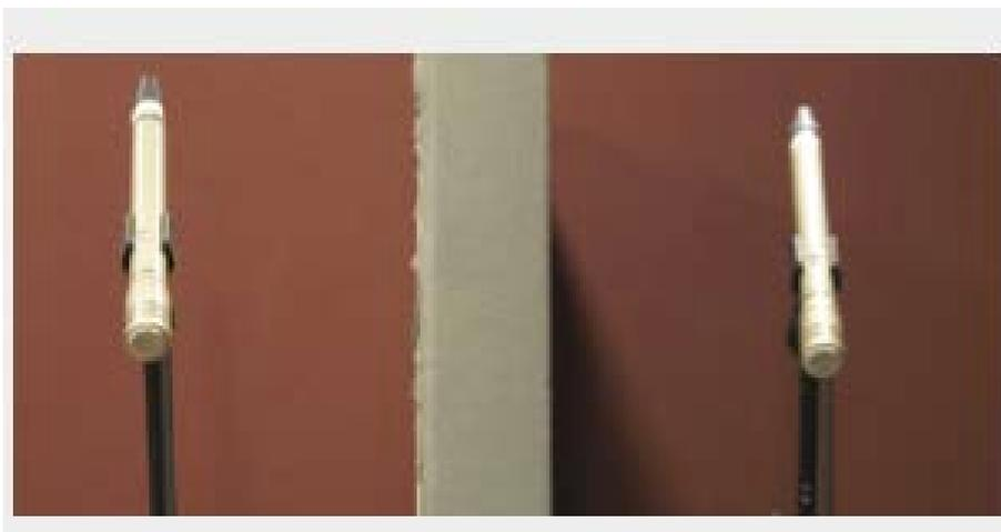
Figura 74. Técnica *Baffled- Pair* , utilizada en el CR3
