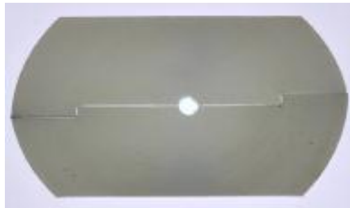
Figura 21 Matriz para la colocación de la resina
