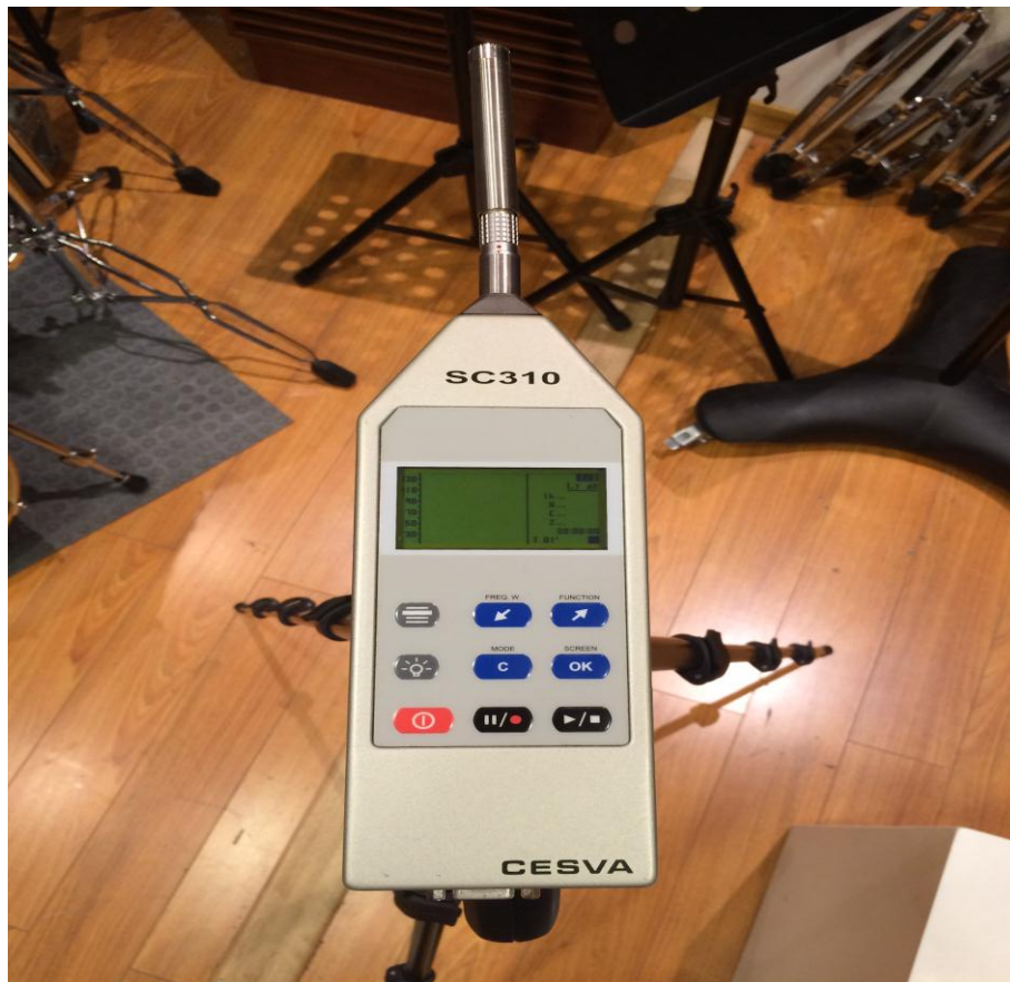
Figura 22. Sonómetro CESVA SC310 de la carrera de sonido de la UDLA.
