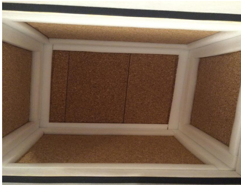
Figura 13. Marco de poliuretano en donde se colocaría la lana de vidrio.
