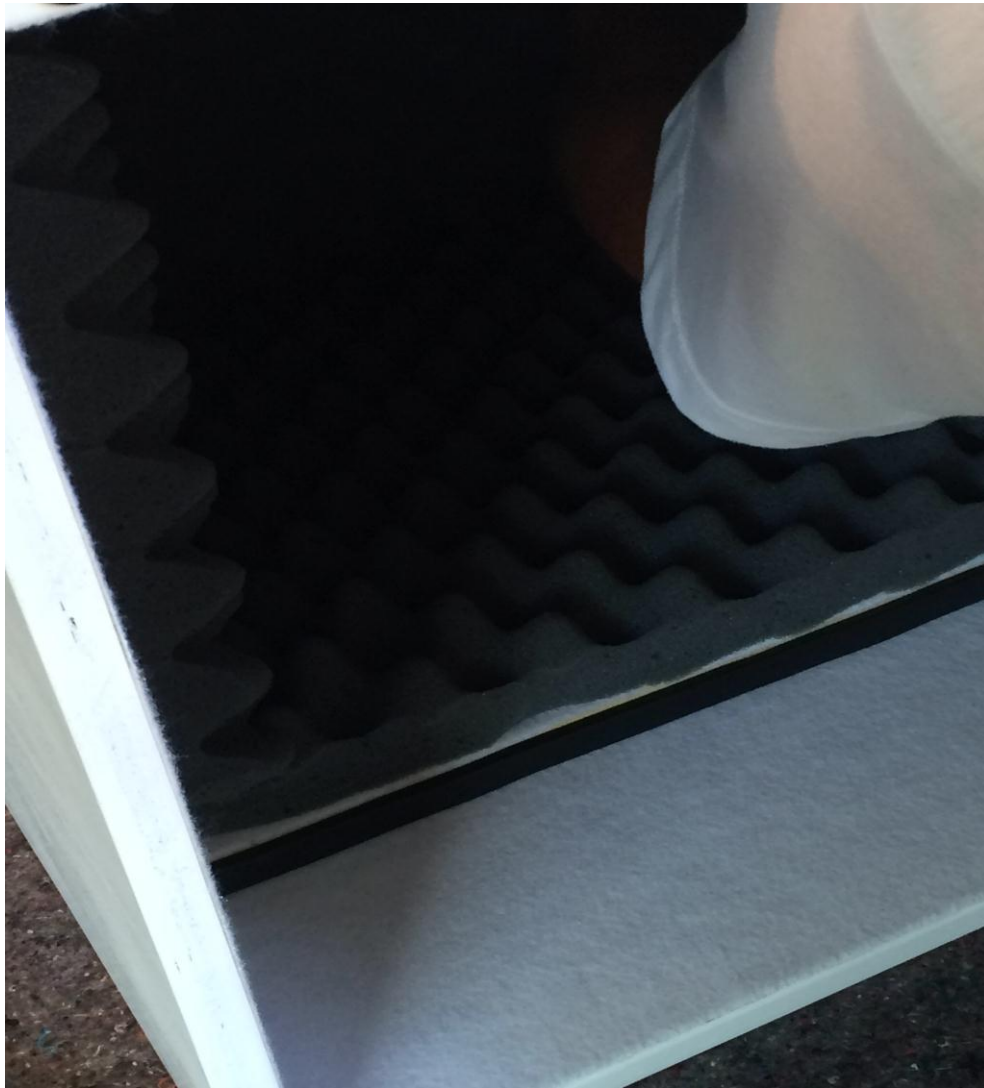
Figura 14. Colocación de la esponja acústica.
