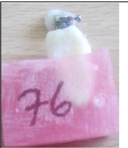
Figura 46 Falla de fractura del esmalte
