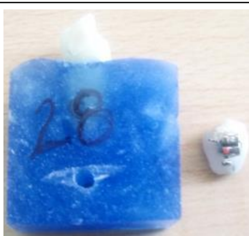
Figura 38 Falla de fractura del esmalte
