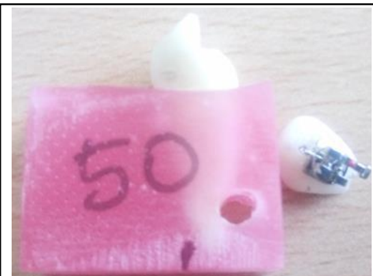
Figura 43 Falla de fractura del esmalte
