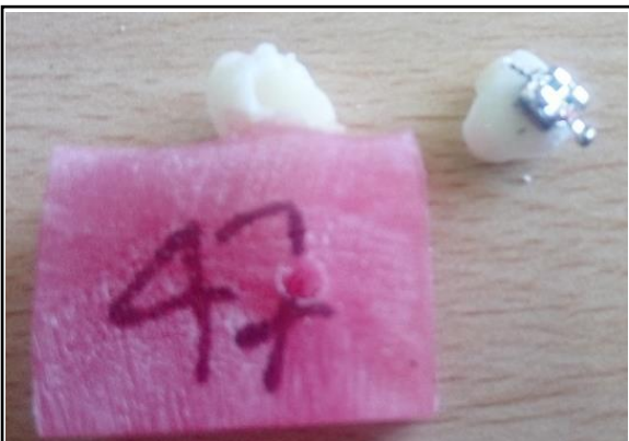
Figura 42 Falla de fractura del esmalte
