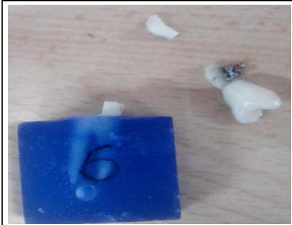
Figura 33 Falla de fractura del esmalte
