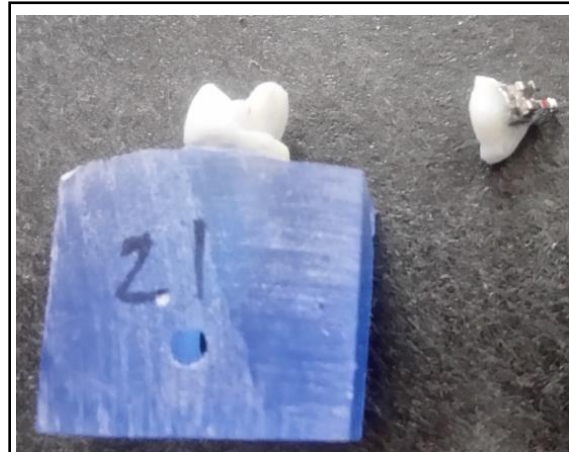
Figura 35 Falla de fractura del esmalte
