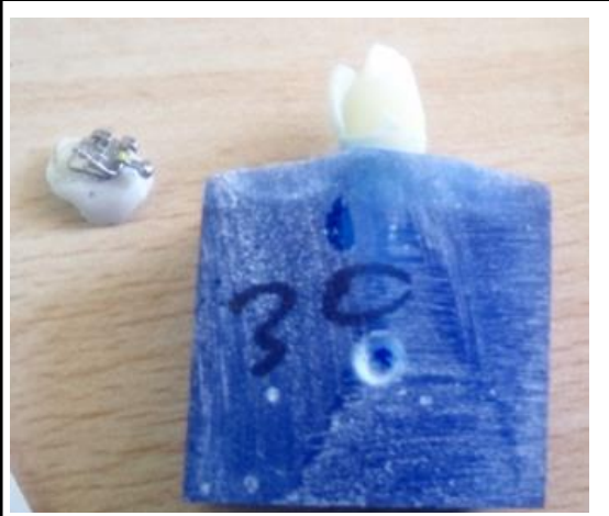
Figura 39 Falla de fractura del esmalte
