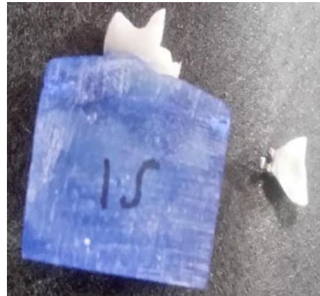
Figura 34 Falla de fractura del esmalte
