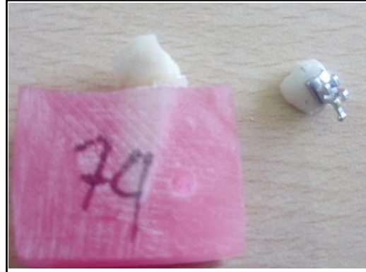
Figura 45 Falla de fractura del esmalte
