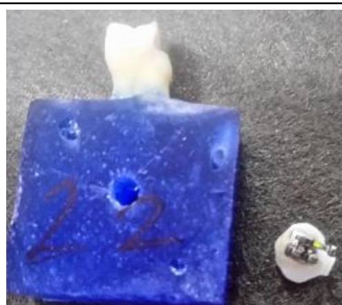
Figura 36 Falla de fractura del esmalte
