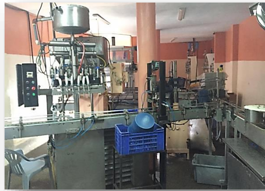
Figura 6. Máquina Envasadora de Botellas 500 cc. Tomado de: Empresa Brisas del Cristal.
