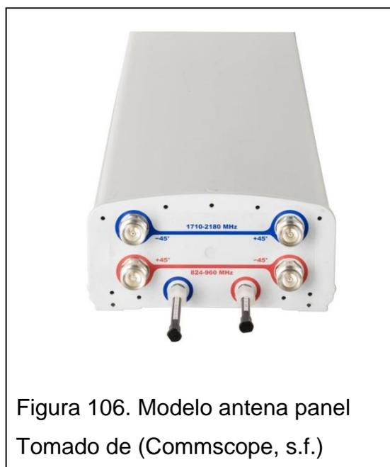
Figura 106. Modelo antena panel
