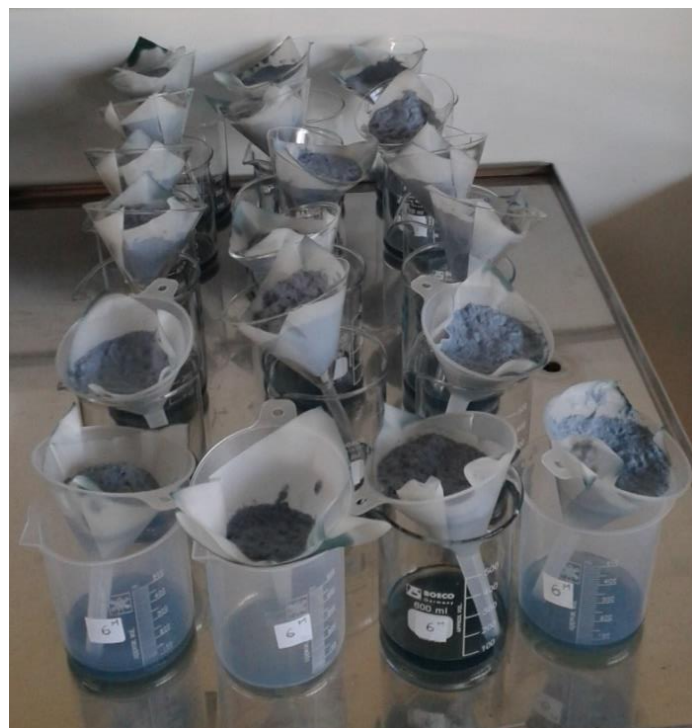
Figura 15: Filtrado de la viruta descurtida
