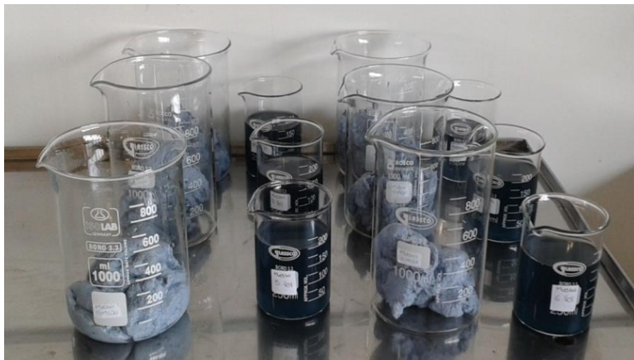
Figura 16: Fase sólida: viruta descortada y Fase líquida: agua con cromo
