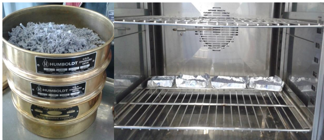
Figura 12: Tamizado y secado de las muestras
