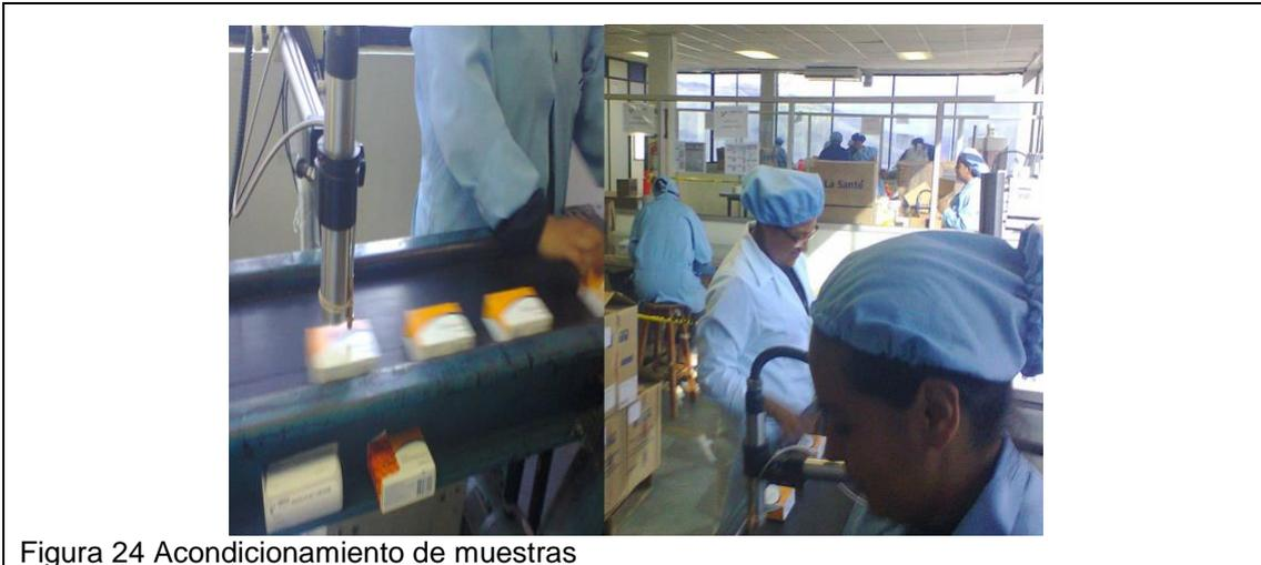
Una vez terminado el proceso de acondicionamiento el material debe ser entregado a personal de calidad para que realice una segunda validación y se realice una inspección aleatoria del producto acondicionado, el muestreo varía dependiendo de la cantidad de la mercancía.
