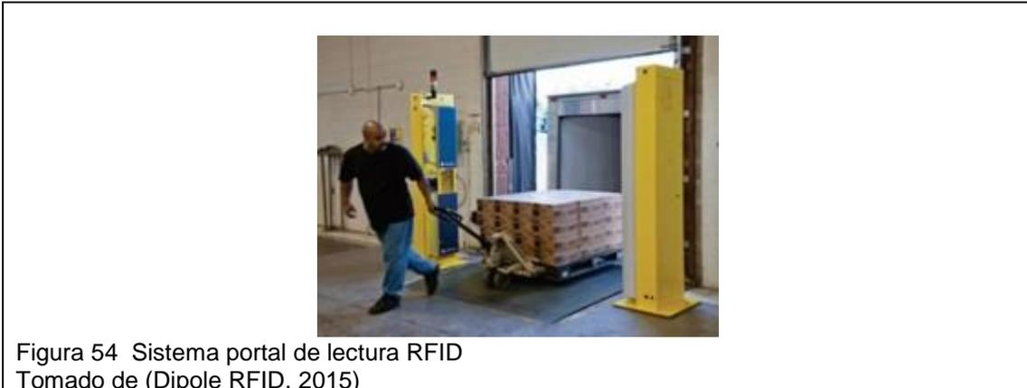
Las antenas que se pueden utilizar en los portales pueden ser las mencionadas anteriormente, se debe considerar al menos 4 antenas por cada portal. Ver *Figura 46 Antena RFID – AN480*
