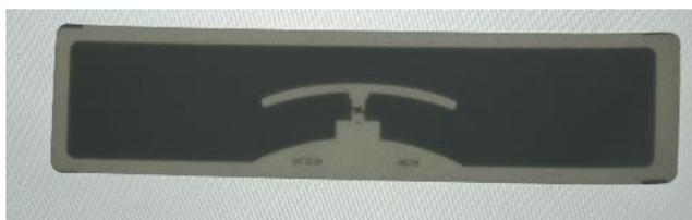
Figura 44 Etiqueta RFID Vista Posterior
