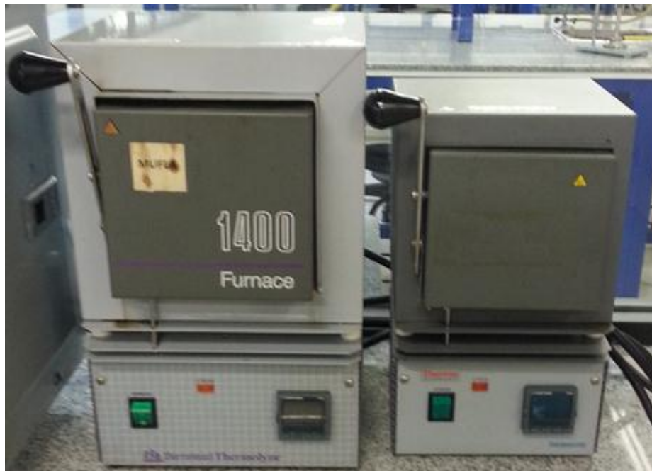
Mufla (Cenizas, Humedad y Fibra)
