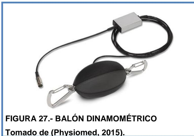
Este balón se conecta a la plataforma y esta a la computadora que la controla a través de un software específico que permite grabar resultados numéricos objetivos.
