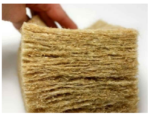
Fotografía del resultado de la mezcla de cáñamo y lino (dos fibras con características propias climáticas y acústicas) Autoconstrucción. (2013). Rellenos Ecológicos. Fotografía #5.
