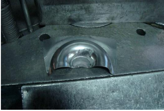
Anexo 4: Conformado de CODO AVEO Tomado de: AMEITX
