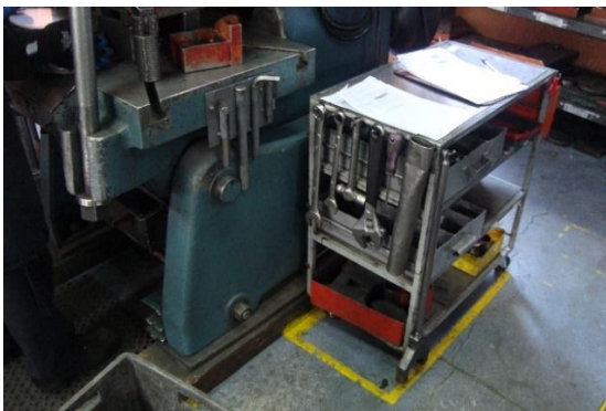
Anexo 5: Herramienta para el montaje de la matriz y regulación de carrera Tomado de: AMEITX
