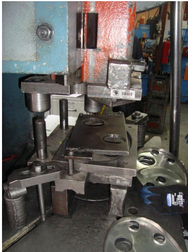
Figura 15: Matriz estacionaria, descansa sobre la bancada de la prensa Tomado de: AMEITX
