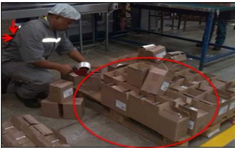
Figura 38. Mala posición por falta de mesa de trabajo.
