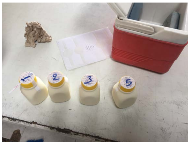
Figura 10. Demostración del medio de transporte de las muestras tomadas de cada uno de los tanques de enfriamiento de leche cruda en el centro de acopio de La Chimba, también se observa el medio de transporte de los tarros de muestras con temperatura controlada.
