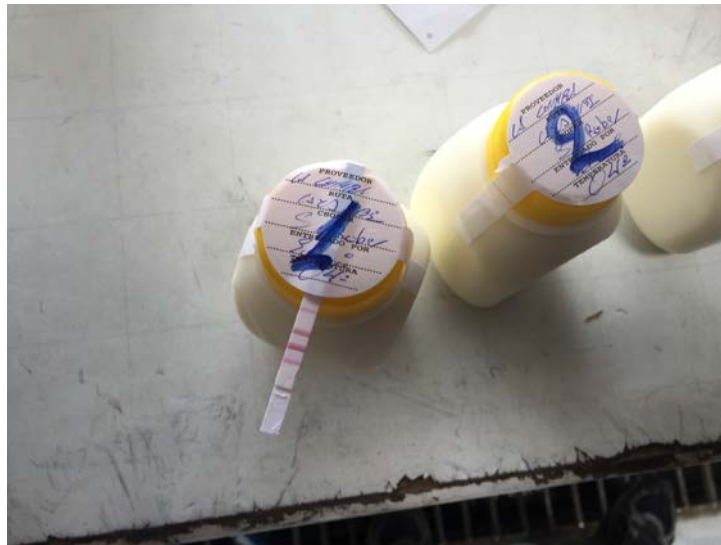
Figura 11. Muestra del examen realizado para la detección de antibiótico en las muestras de la leche cruda que se encuentran en cada uno de los tanques de enfriamiento. Cuando la tira muestra las tres líneas de color violeta significa que la muestra esta libre de antibiótico.
