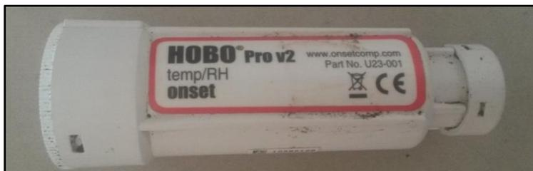
Figura 17. Dispositivos utilizados para el monitoreo de humedad relativa y temperatura (datalogger)
