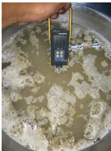
Figura 9. Maceración de la malta molida
