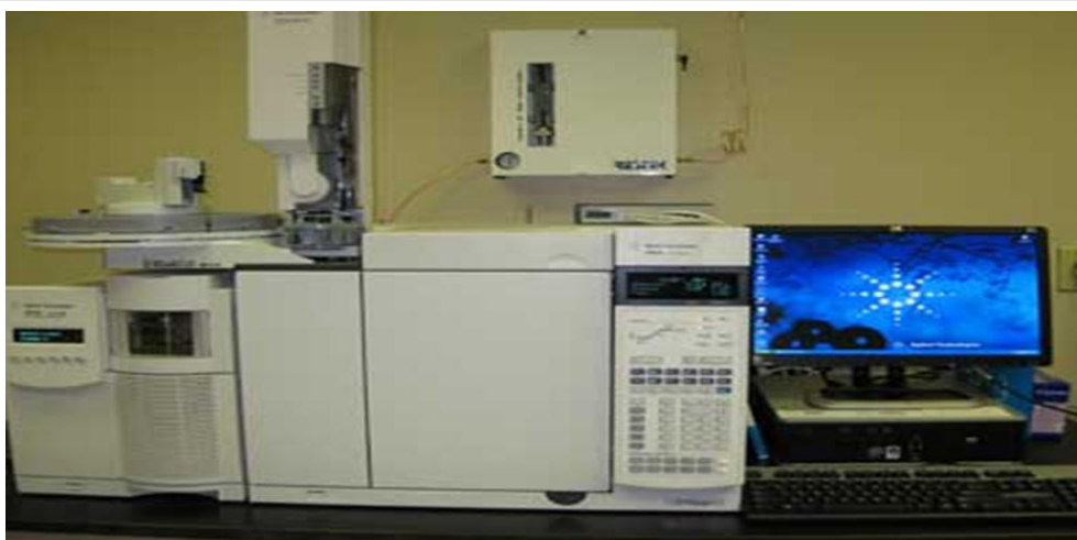
Figura 14. Cromatógrafo de gases con detector FID marca Agilent Technologies 7890A
