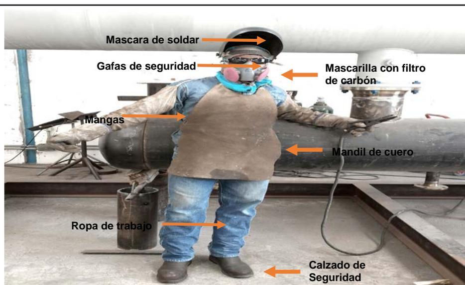
Figura 20 Equipo de Protección personal en Soldadura
