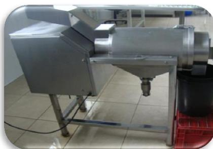
**Figura 71. Despulpadora**
