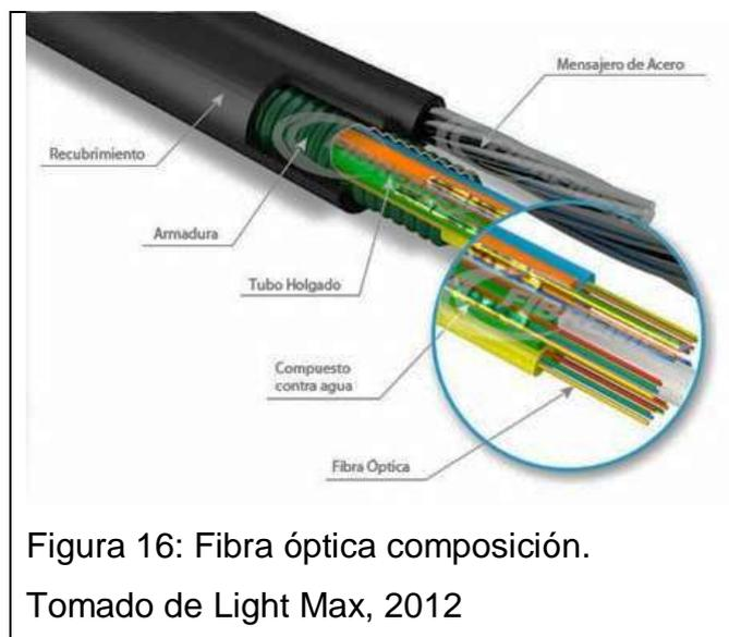
Conduce energía de naturaleza óptica, posee una estructura muy flexible y muy fina, de forma cilíndrica compuesta por tres partes: núcleo revestimiento y cubierta. El núcleo está formado por finas fibras de plástico o cristas. Las fibras están revestidas por cristal o plásticos que poseen diferentes propiedades ópticas que el núcleo, todo esto está cubierto por un plástico que protege de agentes externos como humedad, abrasiones entre otros.
