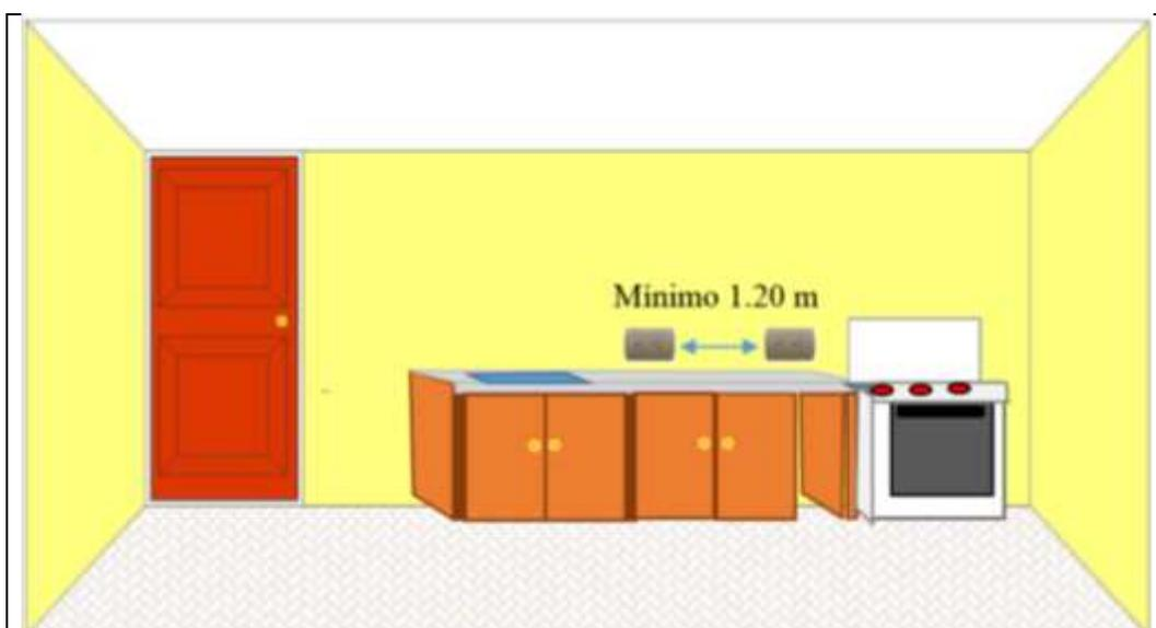
Figura 57. Disposición de tomacorrientes en mesón de cocina
