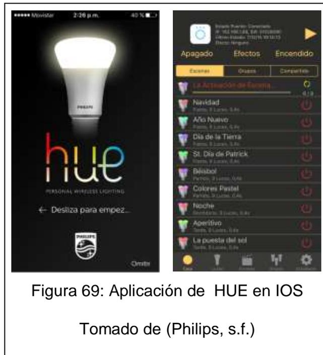
Para iniciar ubicamos el dispositivos de maniobra *dimmer* HUE cerca al dispositivo de maniobra común de iluminación, posterior a la instalación física se procede a incorporar el dispositivo HUE al sistema mediante la aplicación. Todo este proceso se lo puede observar en la figura 70.
