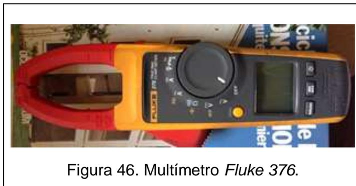
Figura 46. Multímetro *Fluke 376*.
