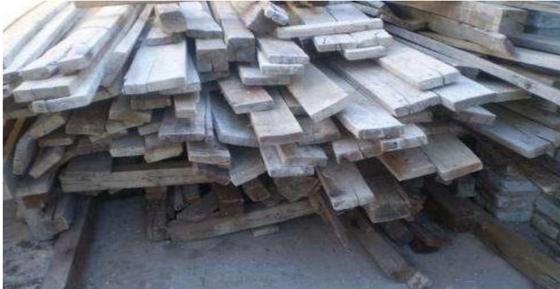
Figura 4: Madera para Encofrado.
