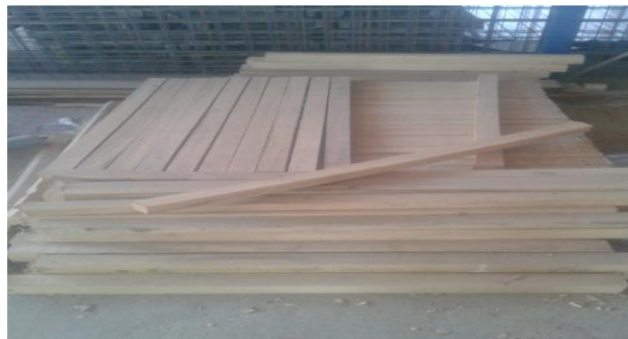
Figura 29: Cuartones cortados para la fabricación de los tableros reciclados.
