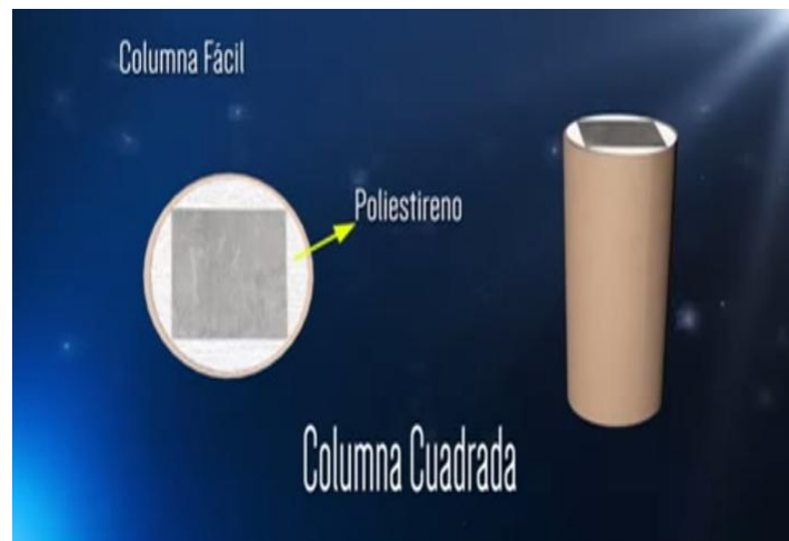
Figura 38: Columna Fácil cuadrada con poliestireno.
